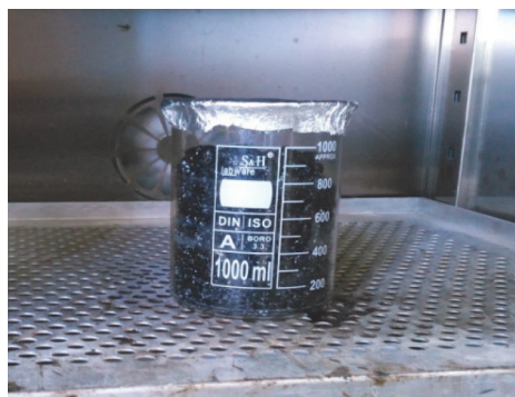
Slika 6. Pripremljeni uzorci SMA mješavine za ispitivanje po Schellenbergu
