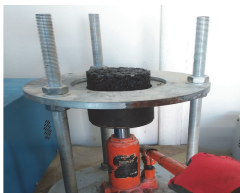
Slika 5. Marshallov uzorak asfalta SMA
